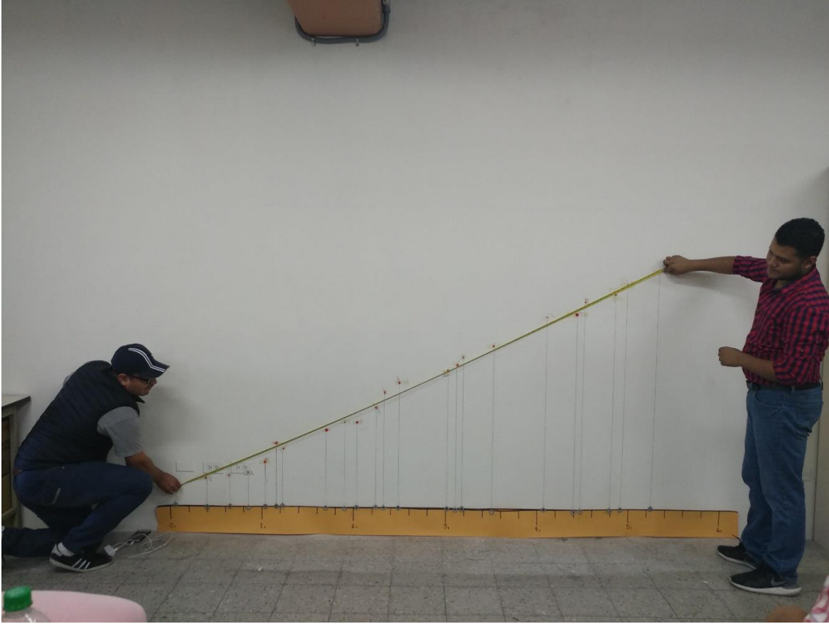
Ilustración 4: Muestra la relación de la longitud y el periodo al cuadrado, una gráfica lineal de donde se obtiene el valor de la pendiente de la recta tangente.
